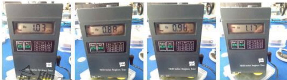
图 6 切割后的试样的表面粗糙度
