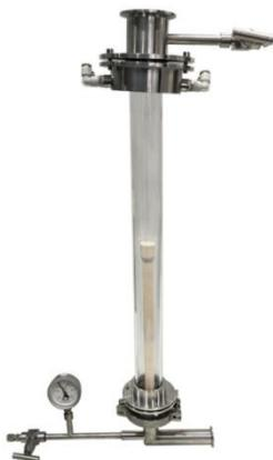
OTF-1700X-PVT 可用于通过 PVT 法（物理气象传输）生长  $\text{SnO}_2$  单晶，在气氛保护环境下，最高温度可达 1700℃。同时也可用此设备采用布里奇曼法生长各种单晶，通过推动坩埚。
