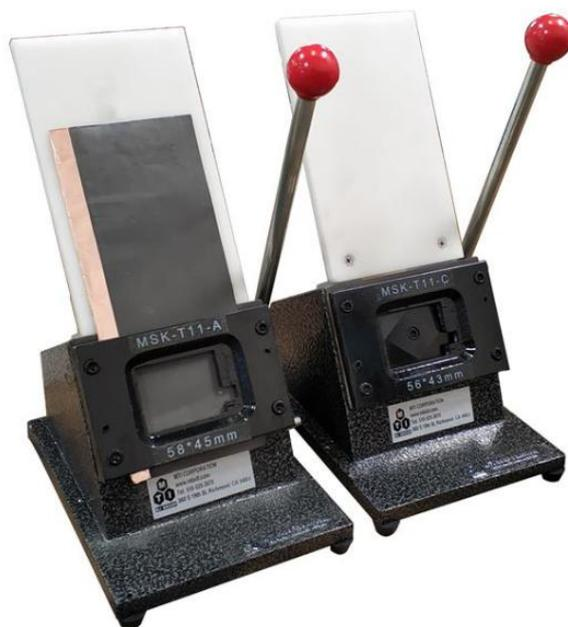
MSK-T-11 是一套手动软包电池切片机（2 台/套），针对于软包电池阴极和阳极切片。其中一款刀模尺寸为 57 mm x 44 mm，用于切阴极片，另一款刀模为 58 mm x 45 mm 用于切割阳极片。
